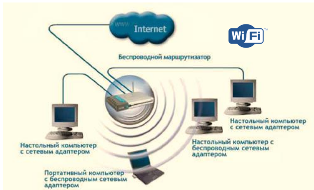
Рис. 4.1 - Использование беспроводного маршрутизатора для организации беспроводной домашней или офисной ЛВС
