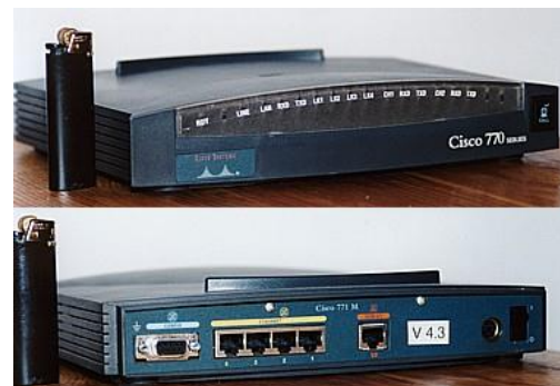
Рис. 3.3- Сетевой шлюз со встроенным коммутатором. Вид спереди (вверху) и сзади (внизу)
