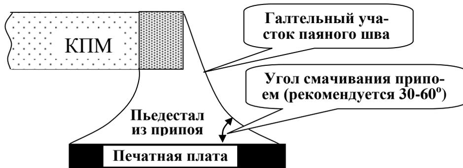
**Рисунок 4.6 - Образование пьедестала из припоя при оплавлении разогретой паяльной пастой контактов КПМ [35]**
