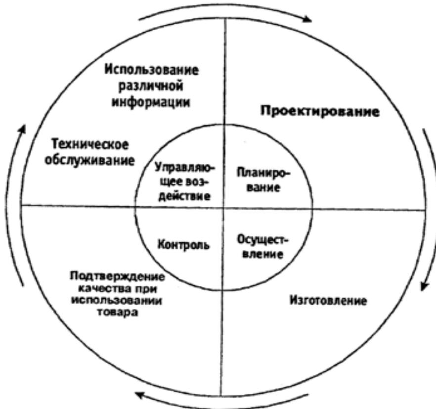
**Рисунок 5.5 - График управления качеством на предприятии с учётом информации о состоянии изделий, полученной во время технического обслуживания в период эксплуатации, и другой информации [52]**
