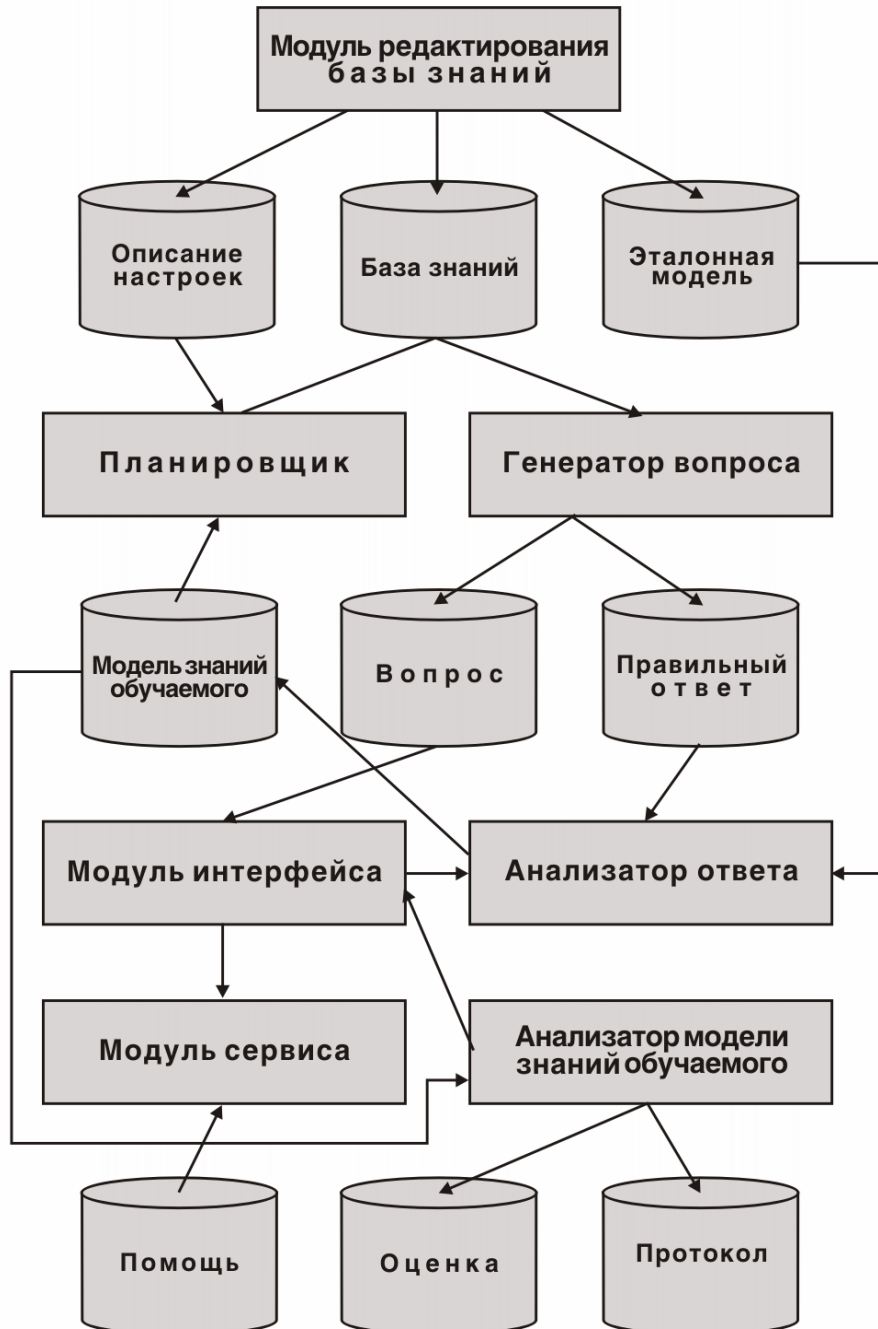
Рис. 4 — Обобщенная структура системы проведения экзамена
