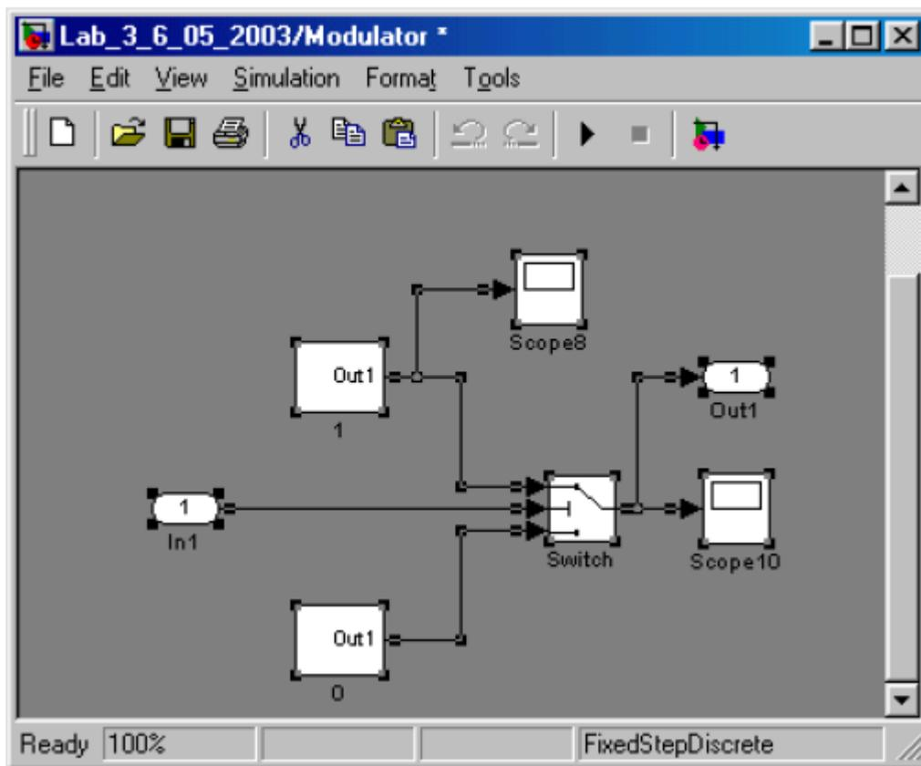
Рис.1. Имитационная модель модулятора
