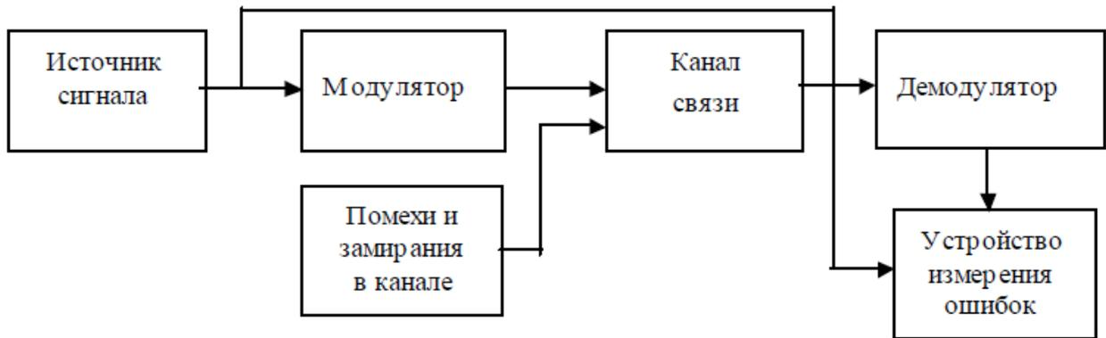
Рис. 5. Структурная схема системы цифровой связи
