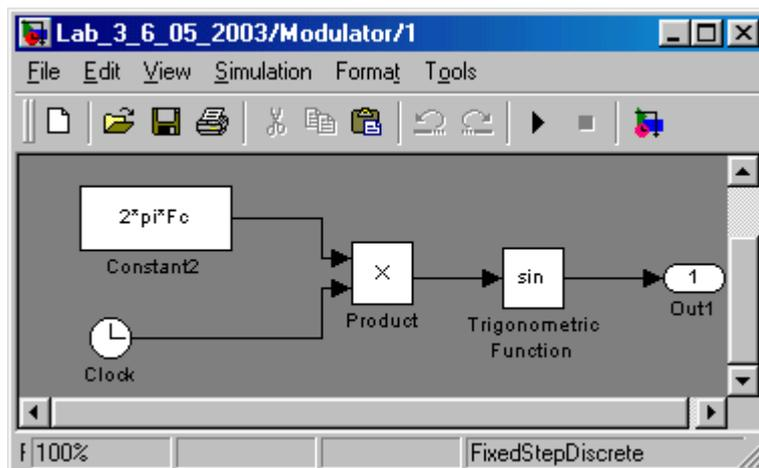
Рис. 3. Имитационная модель ФМн модулятора «1»
