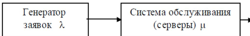
Рис. 1. Схема имитационной модели простейшей СМО
