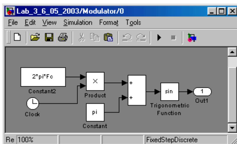
Рис. 4. Имитационная модель ФМн модулятора «0»
