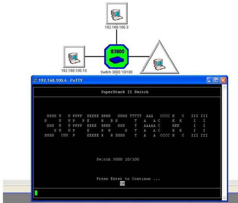
Рис. 7.7. Запуск удаленного терминала для администрирования коммутатора Switch 3000
