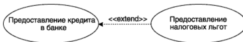
Рис. 4.7. Пример графического изображения отношения расширения между вариантами использования
