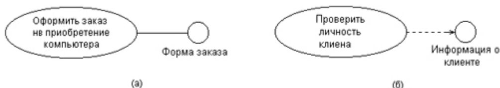
Рис. 4.4. Графическое изображение взаимосвязей интерфейсов с вариантами использования
