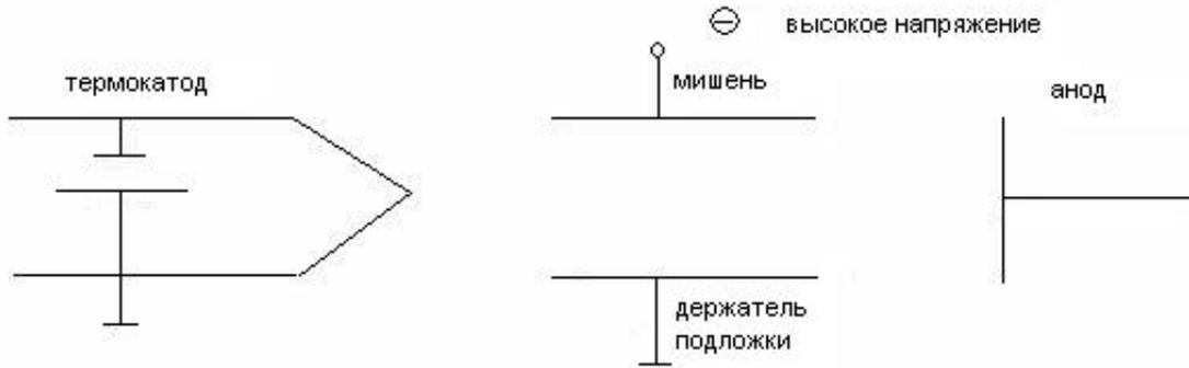
Рисунок 2.1 – Схема ионно-плазменного распыления
