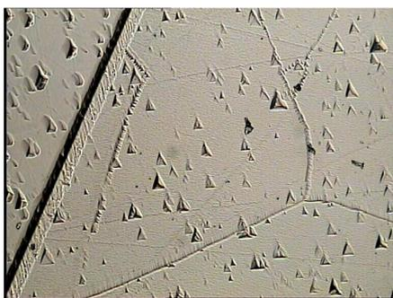
Рис. 3.12. Дислокационные ямки травления на поверхности флюорита, параллельной кристаллографической плоскости (111).
