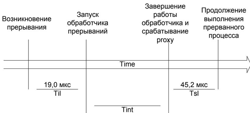
Рис. 4.3. Диаграмма задержки планирования:  $T_{tl}$  — время задержки прерывания;  $T_{int}$  — время обработки прерывания;  $T_{sl}$  — время задержки планирования
