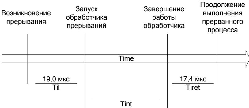
Рис. 4.2. Диаграмма обработки аппаратного прерывания: Ttl — время задержки прерывания; Tint — время обработки прерывания; Tret — время завершения прерывания
