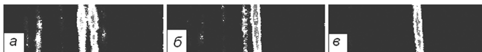
Рис. 6. Картины светового поля на выходной плоскости ФСР в объемном образце \text{LiNbO}_3:\text{Fe} при нелинейной локализации света в одном из элементов: t = 0 (а), 8 (б) и 31 мин (в)
