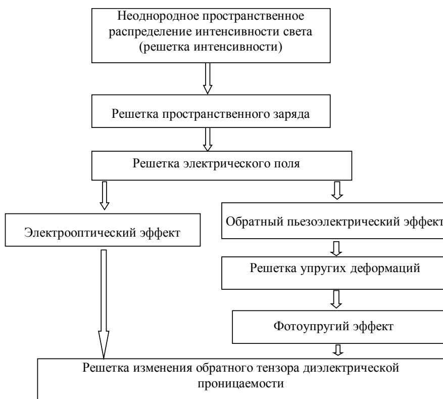
Рис. 1. Структурно-логическая схема механизмов формирования пространственно-периодической структуры, обусловленной светоиндуцированным изменением обратного тензора диэлектрической проницаемости пьезокристалла
