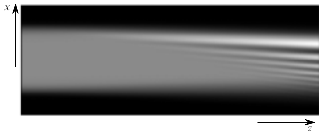
Рис.5. Распределение интенсивности светового пучка с «прямоугольным» профилем при распространении в кристалле длиной 15 мм вдоль оси z для m = 0.5 , E_m = 5 кВ/см, I_d = 0.01 и \mu\tau_r = 2 \times 10^{-12} м 2 /В. Масштаб по поперечной оси x увеличен в 14 раз.
