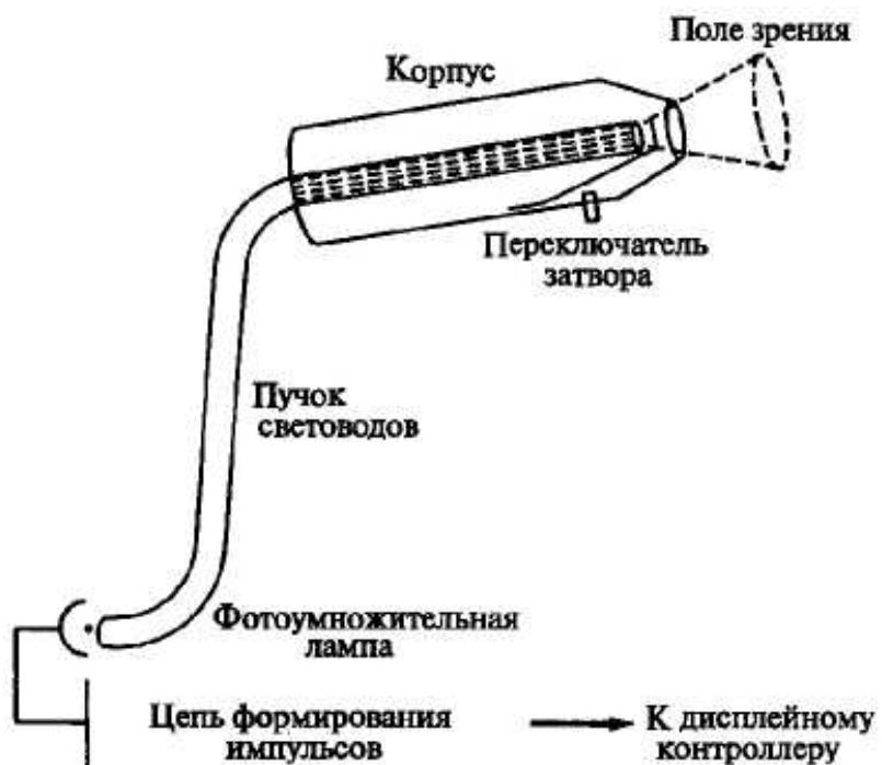
Рис. 10. Схема светового пера.
