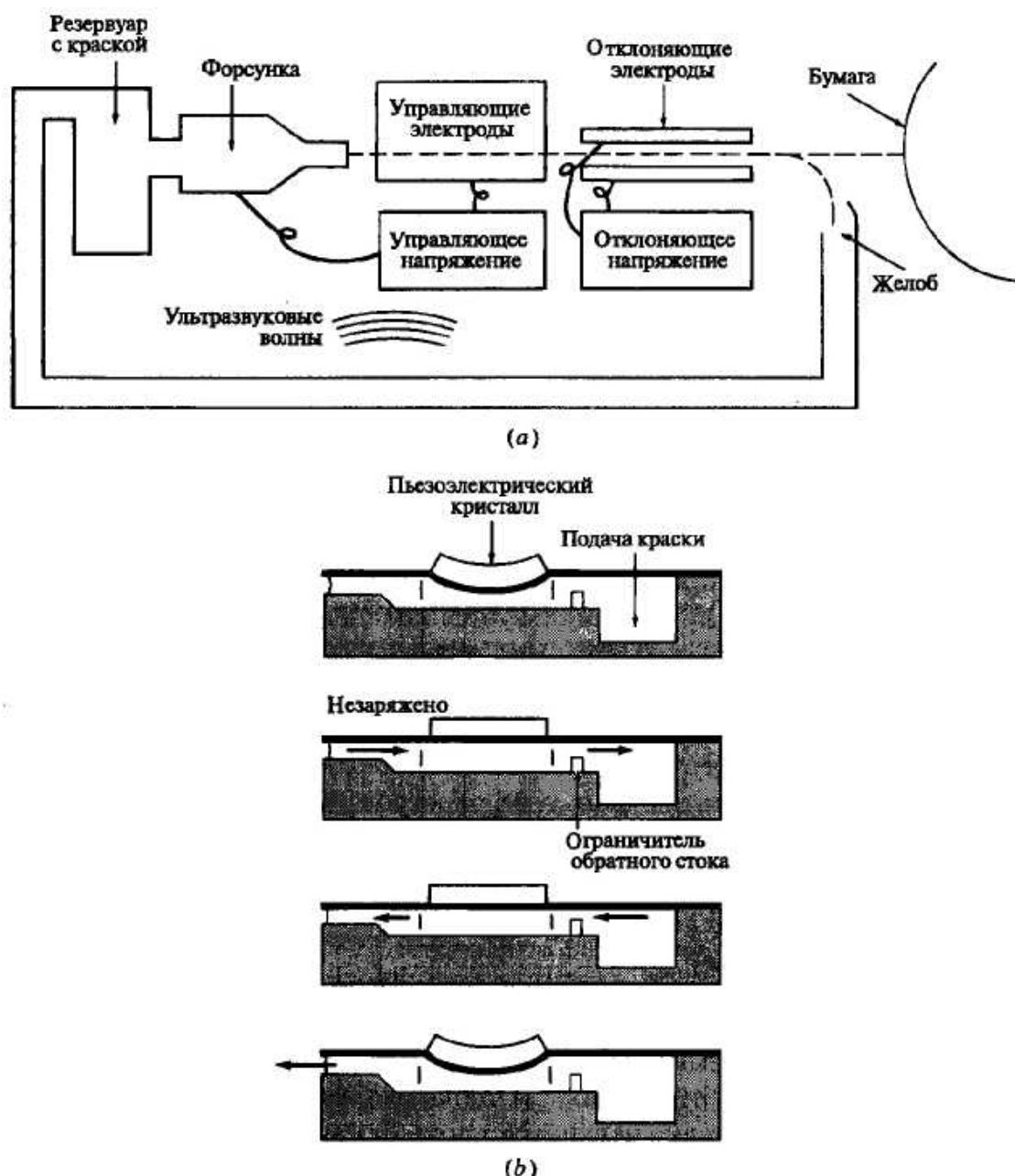
Рис. 26. Принципиальная схема технологии струйной печати: а) непрерывное распыление; б) распыление по запросу.
