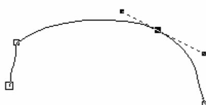
У асимметричного узелка манипуляторы кривизны расположены на одной прямой, но на разном расстоянии от узелка.
