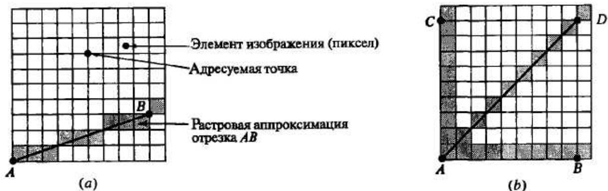
Рис. 12. Растворная развертка отрезка.
