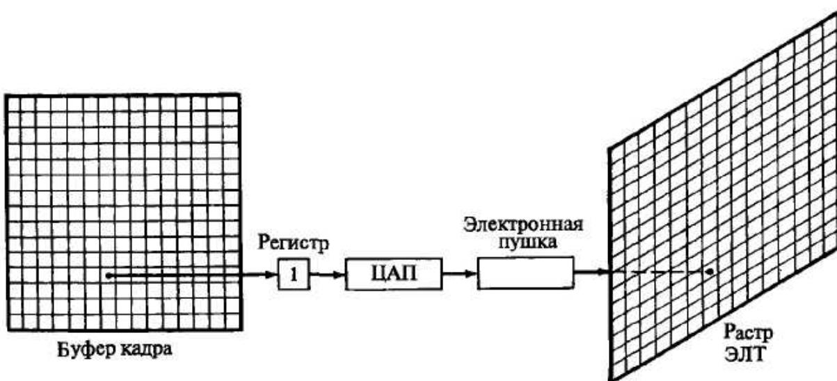
Рис. 13. Черно-белый буфер кадра (с одной битовой плоскостью) для растрового графического устройства.
