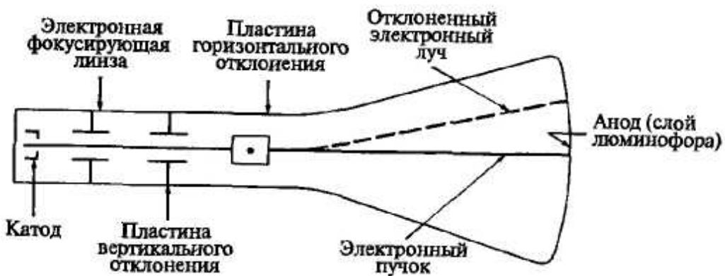
Рис. 18. Электронно-лучевая трубка.
