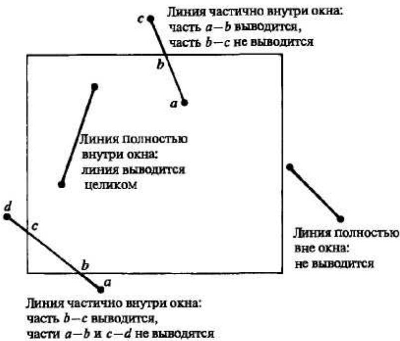
Рис. 2 Двумерное отсечение.
