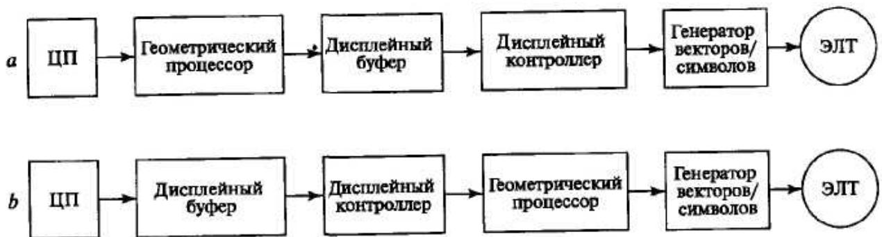
Рис. 11. Концептуальные блок-схемы векторных дисплеев с регенерацией изображения.
