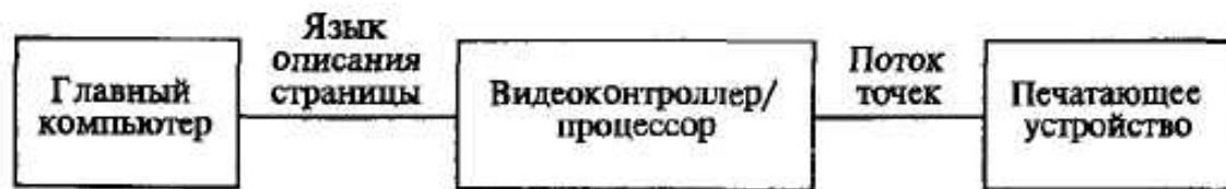
Рис. 24. Конфигурация вычислительной системы лазерного принтера.
