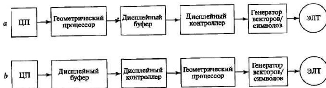
Рис. 11. Концептуальные блок-схемы векторных дисплеев с регенерацией изображения.
