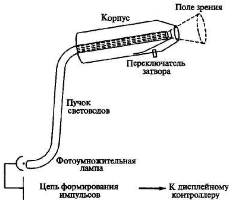
Рис. 10. Схема светового пера.
