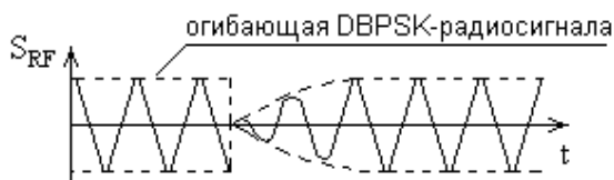
Рис. 1.3. Провал огибающей «фильтрованного» DBPSK-радиосигнала в момент времени, соответствующий скачку фазы на 180^\circ
