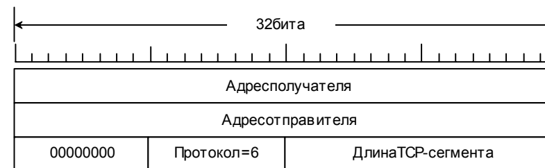
Рисунок 4.10 — Псевдозаголовок, включаемый в контрольную сумму TCP
