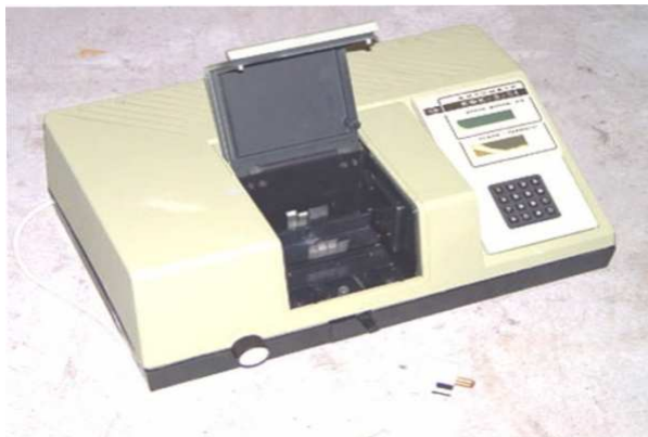
Рис. 1.3 Внешний вид фотоколориметра
