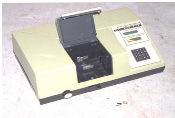
Рис. 1.3 Внешний вид фотоколориметра
