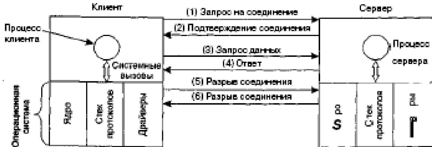
Простейшее взаимодействие клиента и сервера при передаче пакетов по сети с установлением соединения
