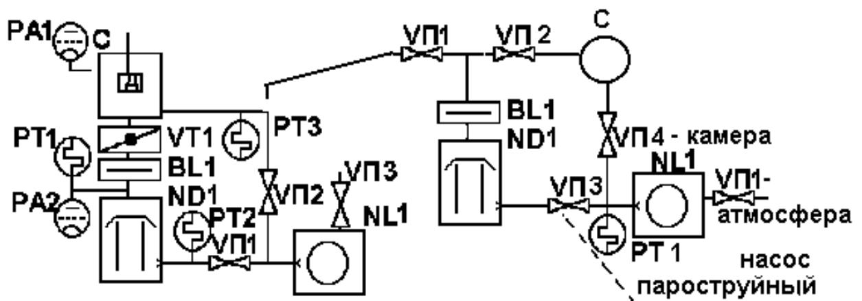
Рисунок 2.1 – Схема типовой вакуумной установки со схемой течеискателя и соответствующими надписями на панели управления
