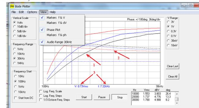
Рис.4.1 Настройки программы для построения АЧХ и ФЧХ передаточной функции
