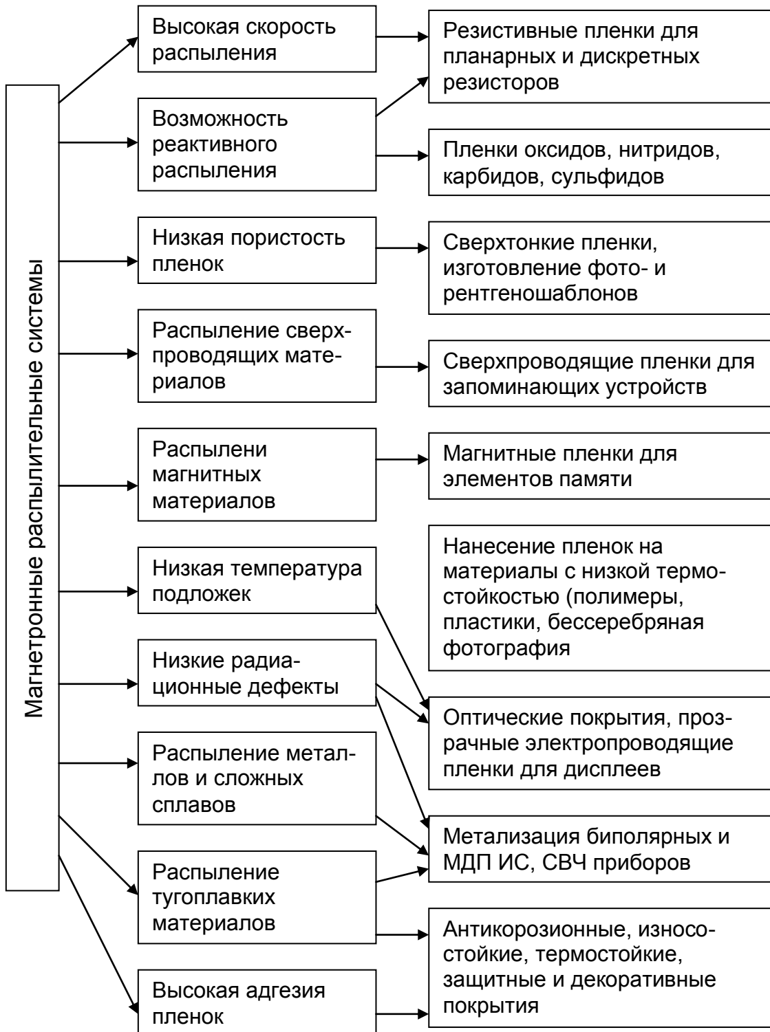
Рисунок 2.2 - Характерные области применения магнетронных распылительных систем
