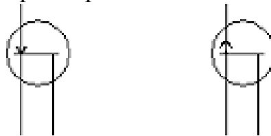
Рисунок 2.2 – Графическое обозначение полевых транзисторов
