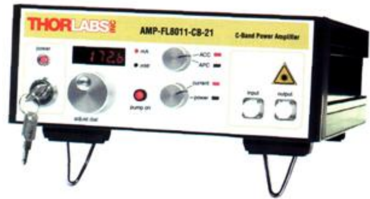
Рис. 2.10 — Внешний вид EDFA производства Thorlabs
