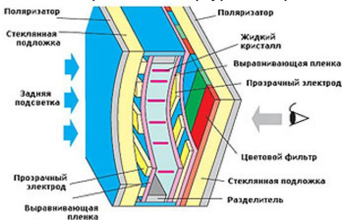
Рис. 9. Структура ячейки жидкокристаллического дисплея.
