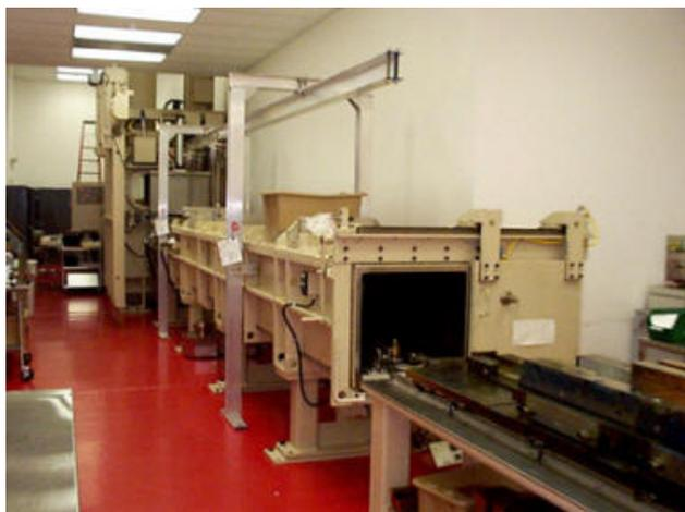
Рис. 2. Система подачи деталей и вакуумная камера установки электронно-дуговой сварки.
