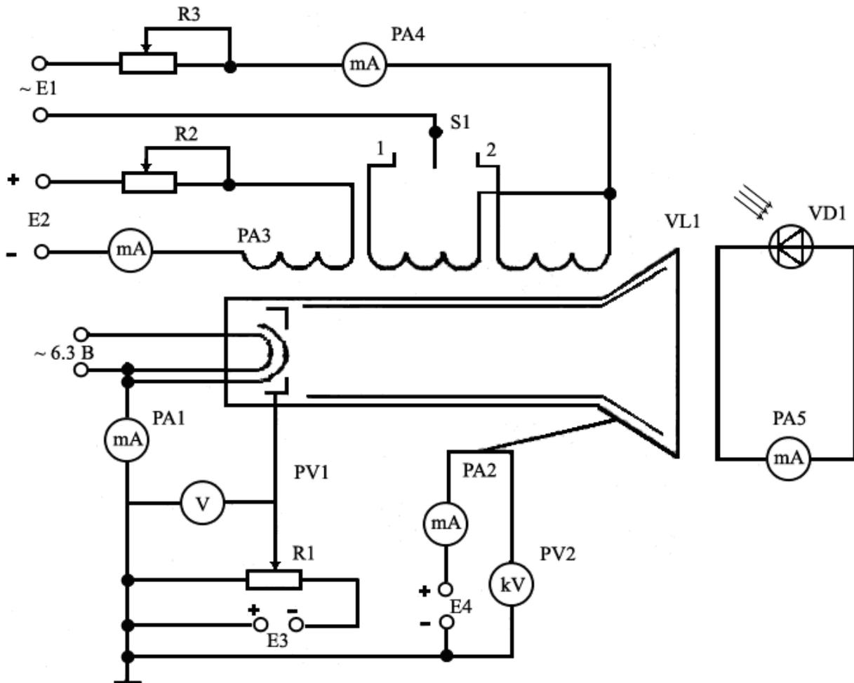
Рисунок 3.1 – Схема для исследования трубки
