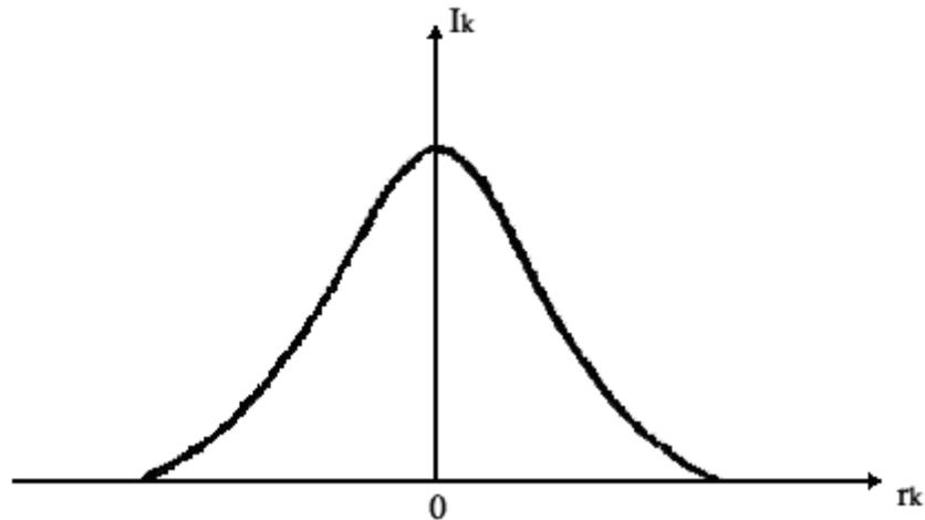
Рисунок 2.1 – Распределение плотности тока по поверхности катода.
