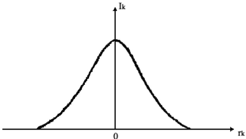
Рисунок 2.1 – Распределение плотности тока по поверхности катода.
