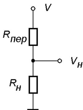
Для определения параметров схемы и условий измерения с ее помощью ВАХ найдем падение напряжения  $V_H$  на сопротивлении нагрузки  $R_H$ . Если к последовательно соединенным  $p-n$  переходу и сопротивлению  $R_H$  приложено медленно меняющееся во времени (например, по пилообразному закону) напряжение  $V$ , то (рис.2)
