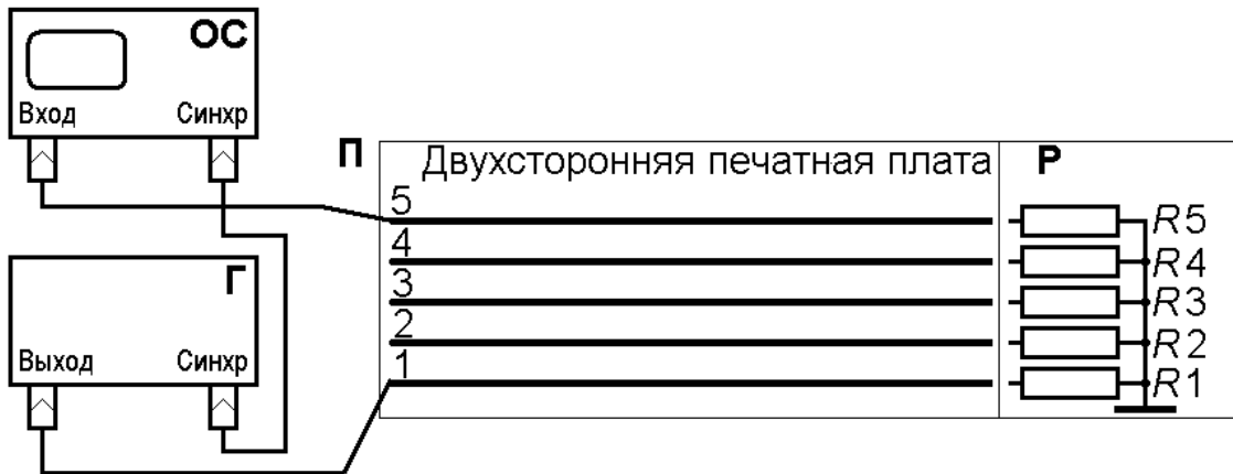
Рис.5. Схема экспериментальной установки: Г – генератор сигналов Agilent 33522A; ОС – осциллограф Agilent MSO7104B; Р – разъем; П – переключатель на 5 положений
