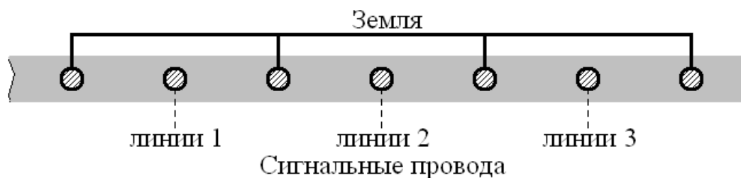
Рис. 2. Линии связи в плоском кабеле в устройствах повышенного быстродействия
