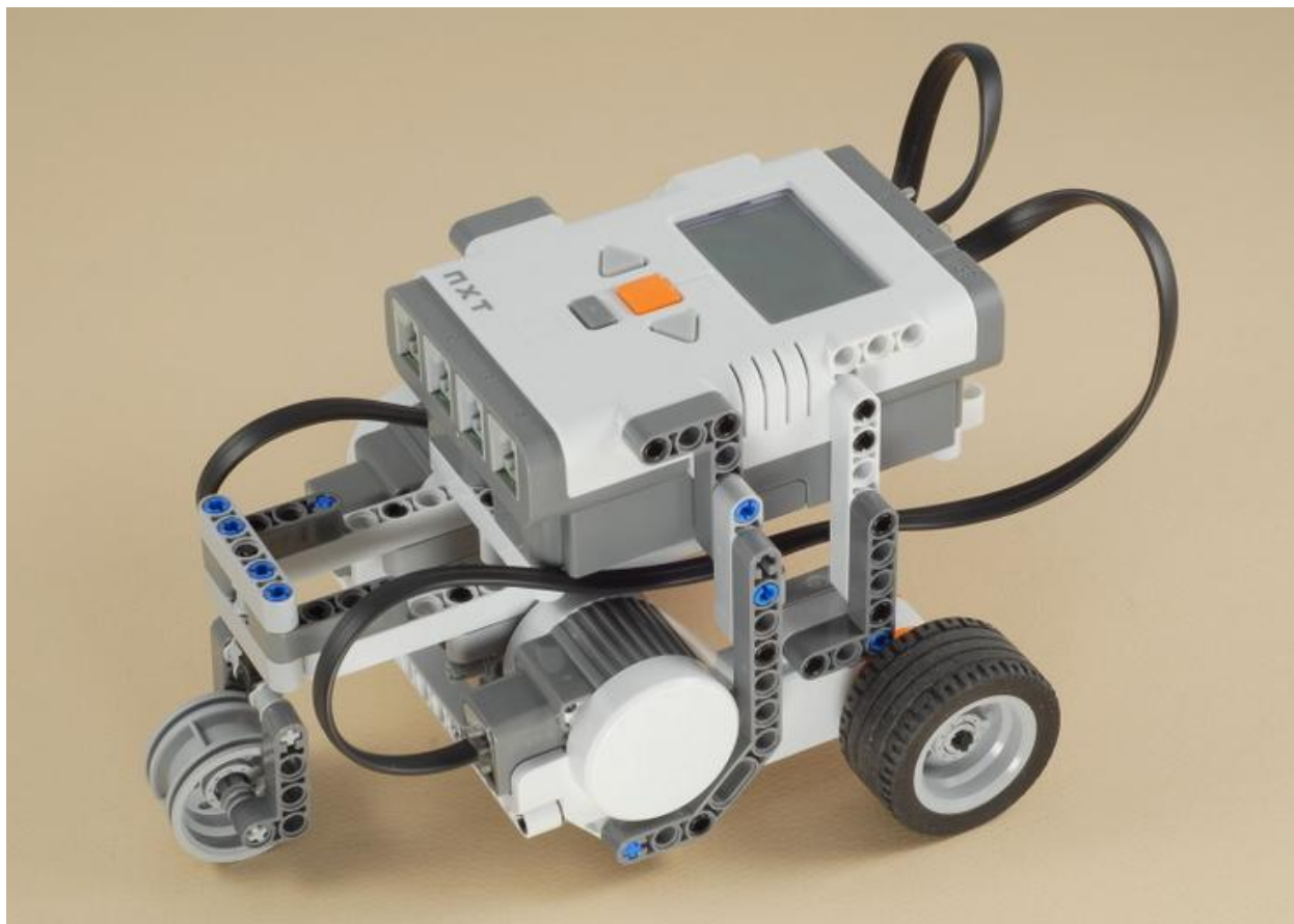
Рис. 3. Тележка мобильного робота с поворотным колесом
