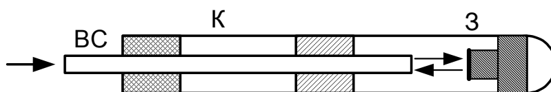
Рис. 2.7. Схема измерителя температуры на основе встроенного ИФП
