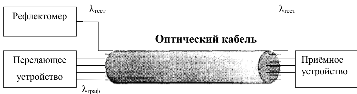
Рис.11.1. Метод контроля оптического кабеля по пассивному волокну.
