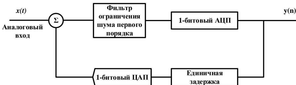
Рисунок 1.29. Сигма-дельта-модулятор первого порядка
