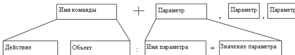
Рис.3 Структура расширенного формата команды с несколькими параметрами
