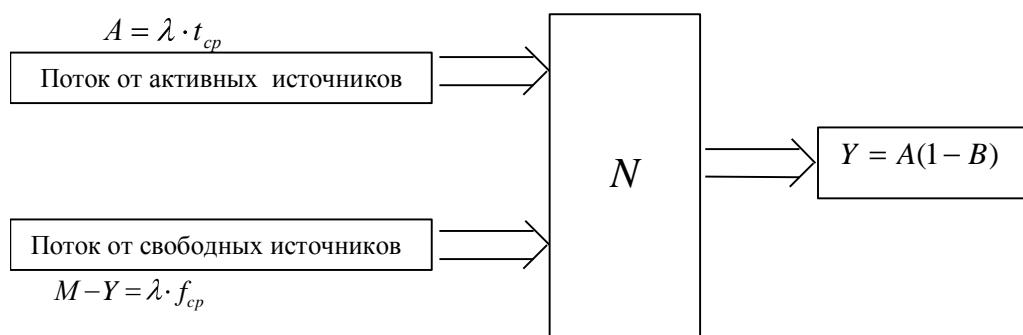
Рис. 5. – Прохождение потоков нагрузки через КС
