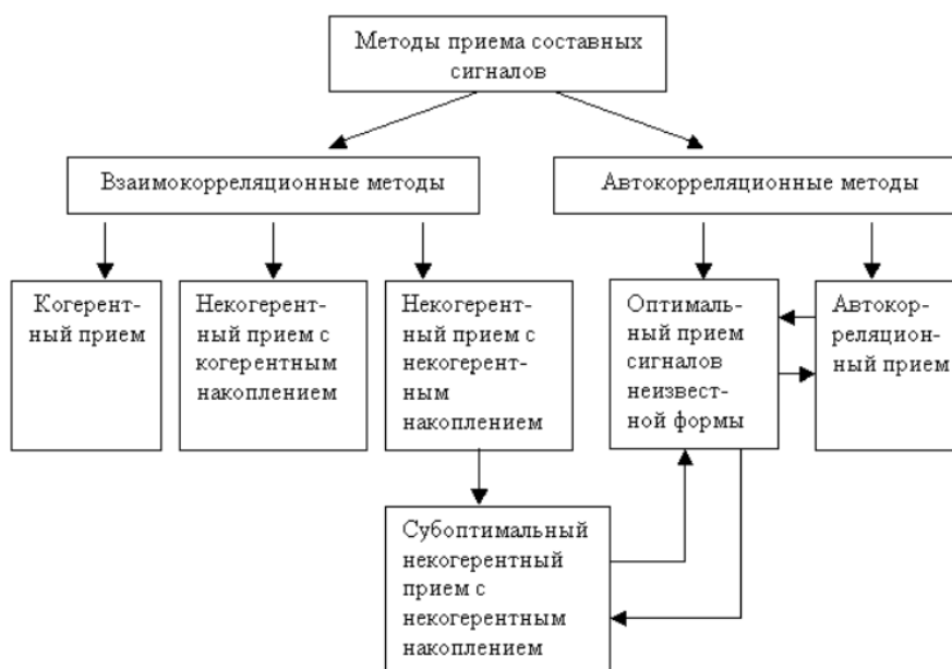
Рис.2.4 Классификация оптимальных методов приема составных сигналов
