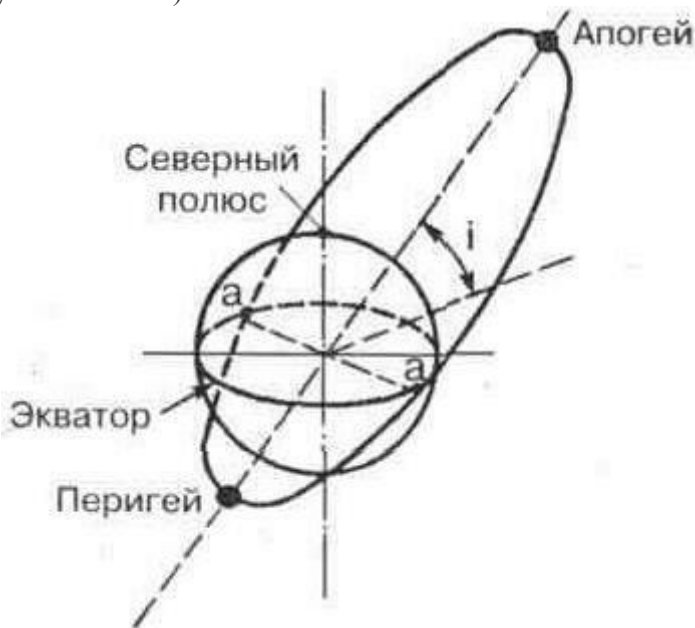
Рисунок 7.1 – Наклонная эллиптическая орбита ИСЗ
