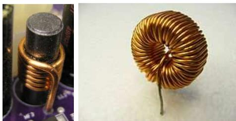
Рисунок 4.1 – Цилиндрическая и тороидальная катушки индуктивности с сердечниками
