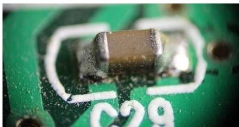
Рисунок 3.1 – Чип-конденсатор на печатной плате
