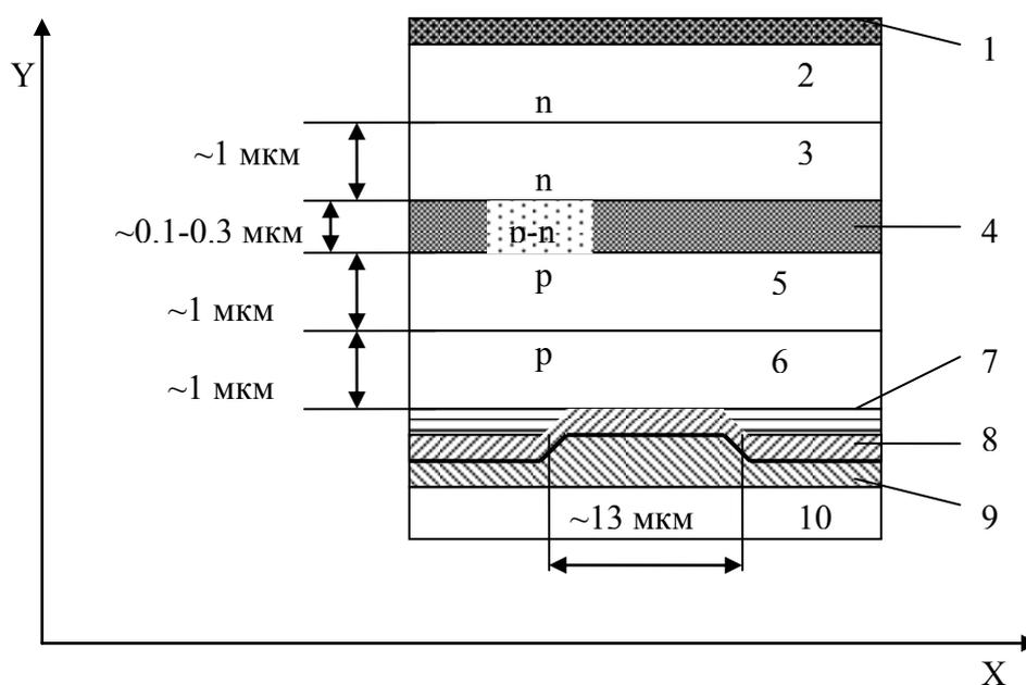
Рисунок 2.3 - Полупроводниковая двойная гетероструктура.
