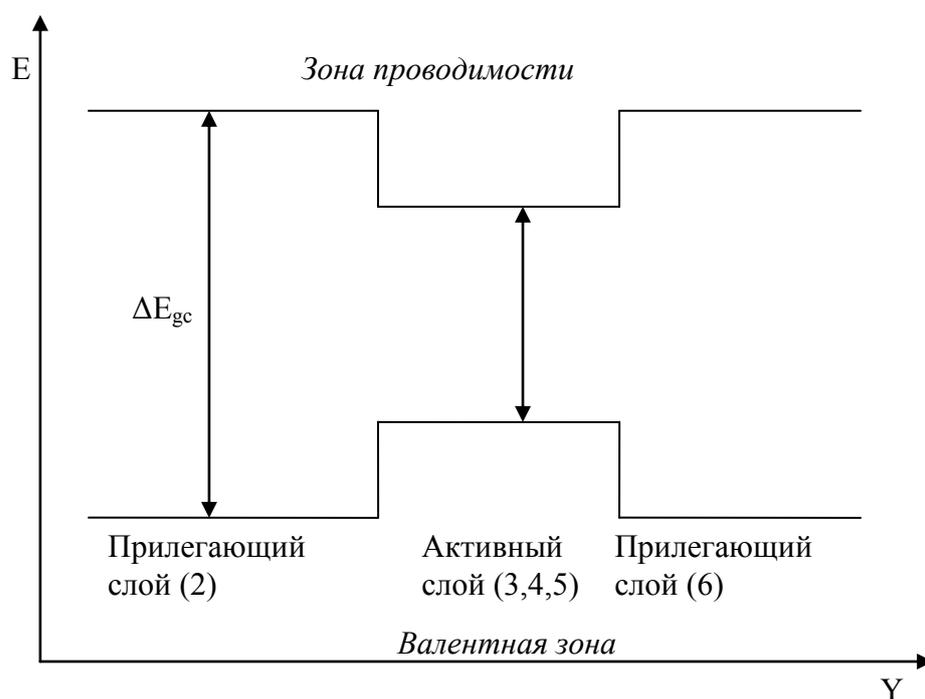
Рисунок 2.4 - Энергетическая схема двойной гетероструктуры, ось Y и номера слоев соответствуют рис. 3.  $\Delta E_{gc}$  – ширина запрещенной зоны;  $\Delta E_{ga}$  – ширина запрещенной зоны p-n-перехода.
