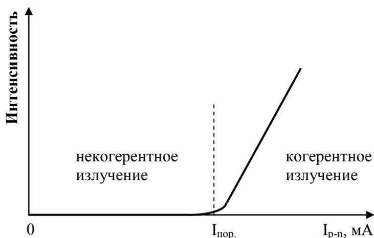
Рисунок 3.3 - Зависимость интенсивности излучения лазера от тока, протекающего через р-п переход.  $I_{пор.}$  – величина порогового тока.
