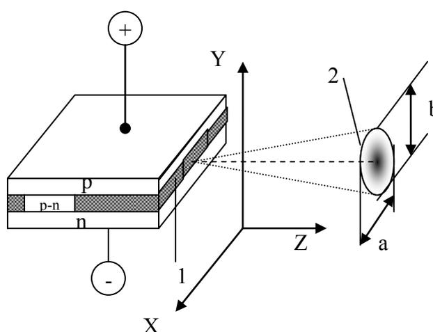
Рисунок 2.2 - Принципиальная схема лазера на р-п-переходе. 1 – область р-п перехода (активный слой); 2 – сечение лазерного пучка в плоскости X-Y.
