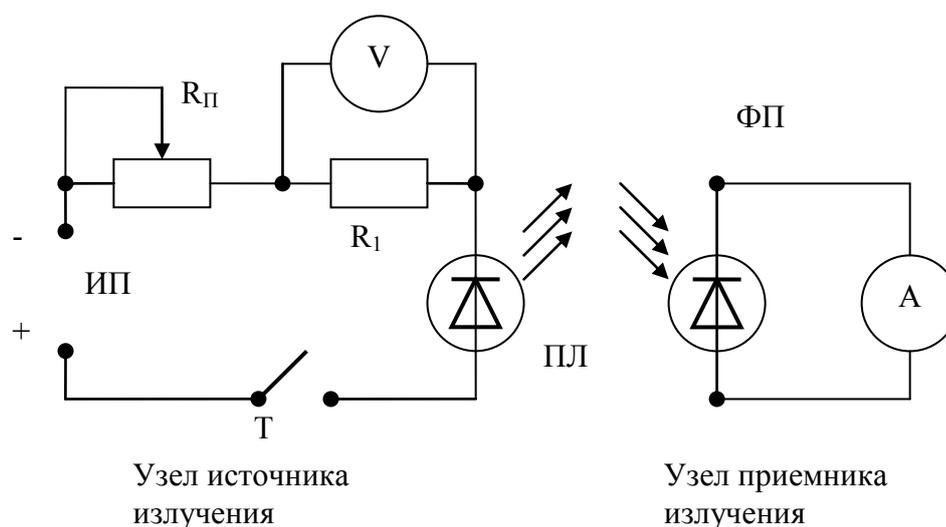
Рисунок 3.2 - Электрическая схема установки для исследования зависимости интенсивности излучения полупроводникового лазера от величины тока, протекающего через р-п переход; ПЛ – полупроводниковый лазер, ФП – фотоприемник, ИП – источник питания постоянного тока 4,5 В,  $R_1$  – постоянное сопротивление,  $R_П$  – переменное сопротивление, Т – тумблер для включения и выключения питания лазера, V – вольтметр (мультиметр), А – амперметр (мультиметр).
