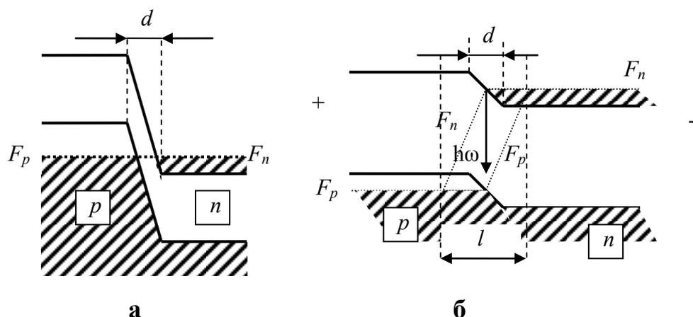
Рисунок 2.1. Энергетическая диаграмма инжекционного полупроводникового лазера: а) р-п переход без приложенного внешнего напряжения, б) р-п переход при приложении внешнего напряжения в прямом направлении;  $d$  – ширина р-п перехода,  $l$  – реальная ширина области, обеспечивающей работу лазера
