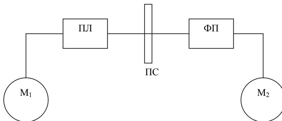
Рисунок 3.1 - Блок-схема экспериментальной установки: ПЛ – полупроводниковый лазер, ПС – поляризационный светофильтр, ФП – фотоприемник,  $M_1$  и  $M_2$  – измерительные приборы (мультиметры).
