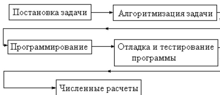
Рисунок 1.1. Схема решения задачи на цифровой ЭВМ.
