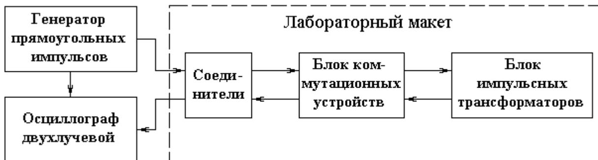
*Рисунок 3.1 Структурная схема лабораторной установки*
