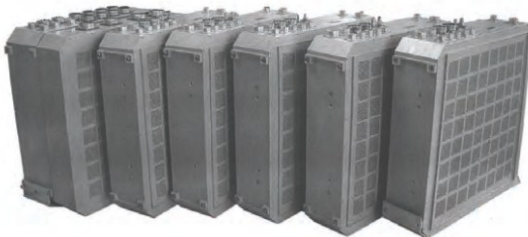
Рисунок 10.13. Комплекс автоматики и стабилизации напряжения космического аппарата «Ресурс-ДК1» [7]
