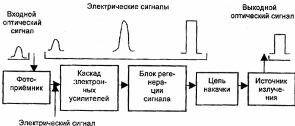
Рис. 3.31 — Электронно-оптический повторитель
