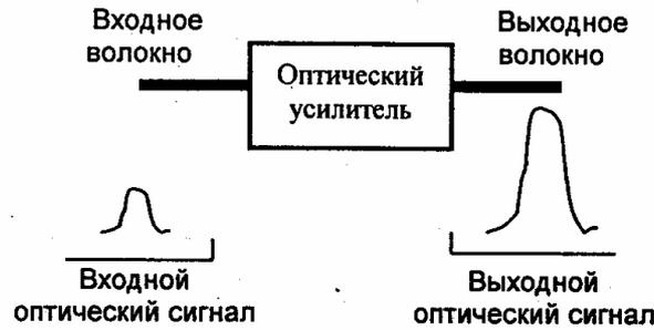
Рис. 3.32 — Оптический усилитель
