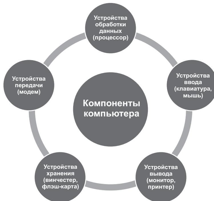
Рис. 2.5 – Компоненты компьютера
