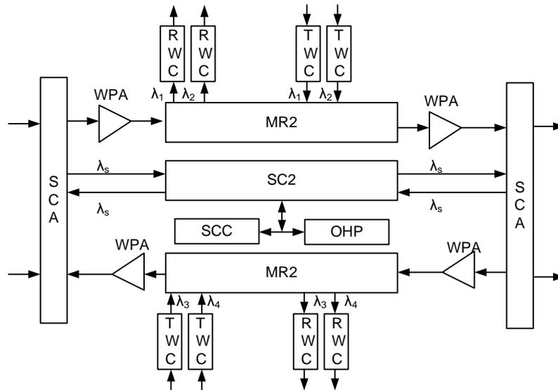
MR2 - блок мультиплексирования ввода/вывода 2-х каналов, WPA - WDM блок предварительного усилителя, WBA - WDM Блок усилителя-бустера, TWC - STM-16 Передающий блок преобразования длины волны, RWC - STM-16 Принимающий блок преобразования длины волны
