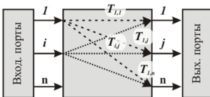
Рисунок 1.3 – Структурная схема многопортового  $N \times N$  распределителя
