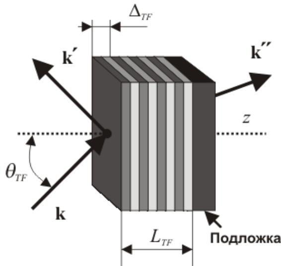
Рисунок 2.1 – Конструкция интерференционного фильтра, где  $\blacksquare$  и  $\square$  – слои с показателями преломления  $n_1$  и  $n_2$ ,  $L_{TF}$  – толщина структуры,  $\Delta_{TF}$  – период структуры,  $\mathbf{k}$ ,  $\mathbf{k}'$ ,  $\mathbf{k}''$  – волновые вектора падающей, отражённой и прошедшей световых волн,  $\theta_{TF}$  – угол падения волны.
