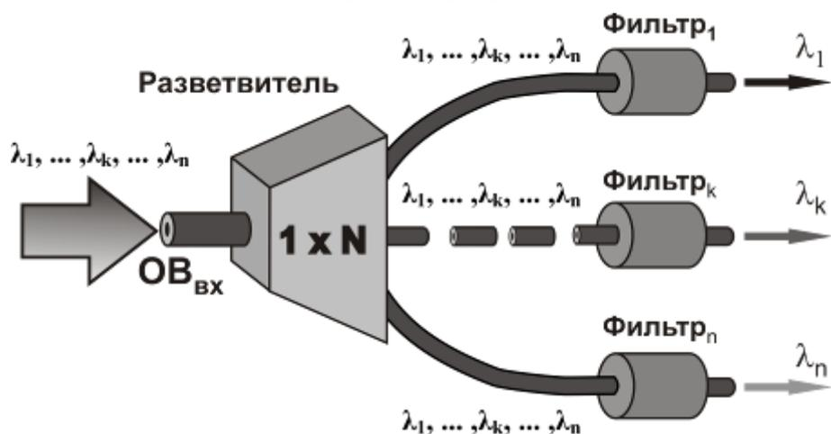
Рисунок 3.2 – Схема оптического демультиплексора многоволнового сигнала.
