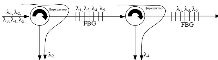
Рис. 1.11 -Схема демультиплексора WDM на основе решетк Брэгга
