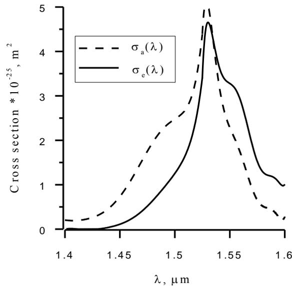
Рисунок 2.2 - Эффективные сечения поглощения ( $\sigma_a$ ) и излучения ( $\sigma_e$ ).
