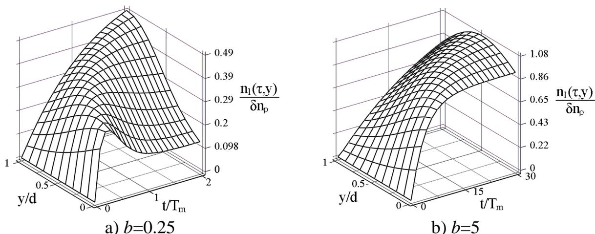
Рисунок 2.7 – Пространственно-временные профили нормированной амплитуды первой гармоники показателя преломления, где  $b=T_p/T_m$ ,  $T_m = 1/K^2 D_m$  – время диффузии мономера,  $T_p$  – время полимеризации.
