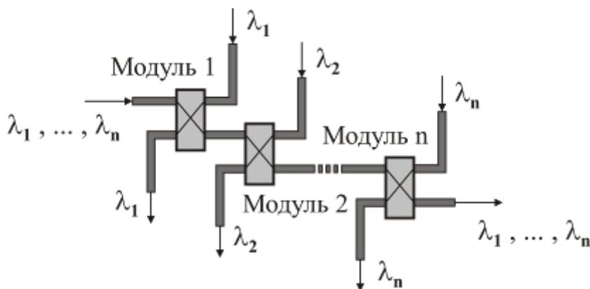
Рисунок 2.4 – Мультиплексор/демультиплексор на основе интерферометров Маха-Цендера.
