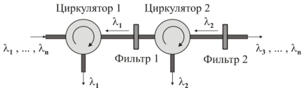
Рисунок 2.5 – Демультимплексор на основе циркулятора.
