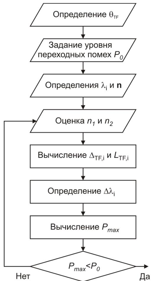
Рисунок 2.10 – Блок-схема построения демультиплексора на основе интерференционных фильтров.
