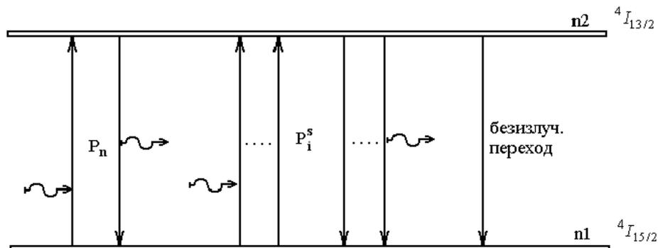
Рисунок 2.1 - Диаграмма рабочих уровней при наличии накачки и информационных сигналов.
