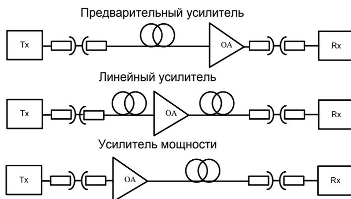
Рисунок 1.5 - Применение разных типов оптических усилителей
