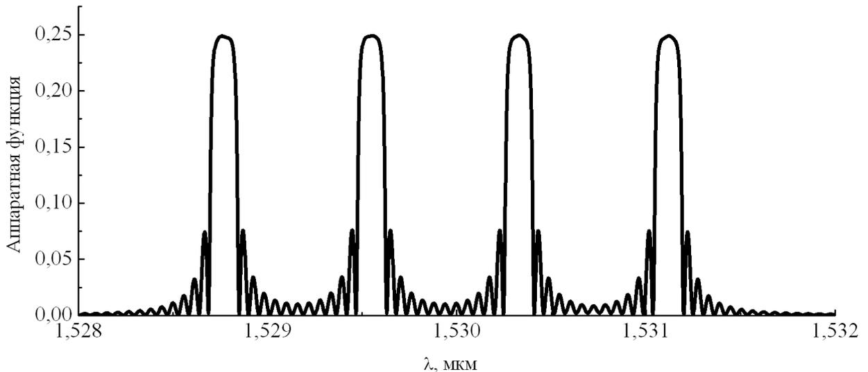
Рисунок 2.11 – Аппаратная функция демультиплексора на основе интерференционных фильтров.
