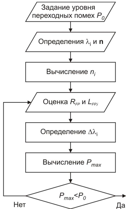
Рисунок 3.5 – Блок-схема построения демультиплексора на основе фильтров Фабри-Перро.
