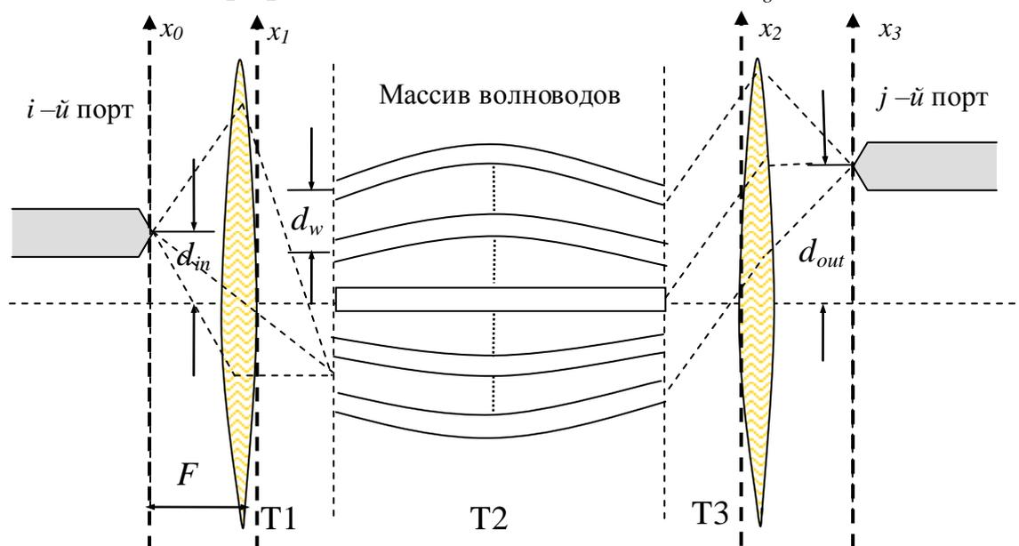
Рисунок 2.4 - Оптическая схема AWG
