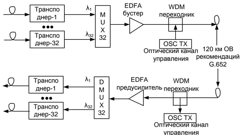
Рис. 1.9 - Структура **ОТМ OptiX BWS 320G**
