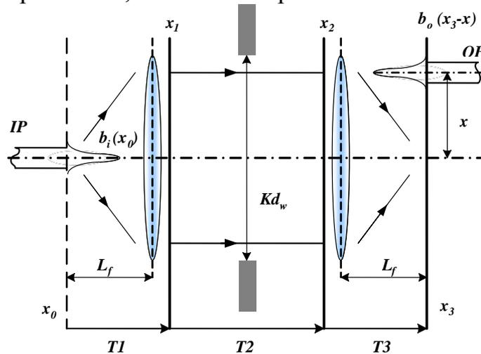
Рисунок 2.5 – Соответствие операторов преобразования физическому прохождению сигнала
