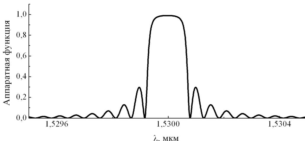
Рисунок 2.8 – Типичный вид аппаратной функции интерференционного фильтра.
