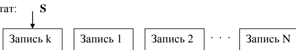
Рис. 20. Включение записи k в стек
