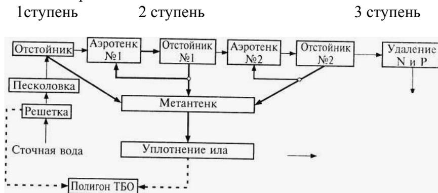
Рисунок 2.3.1. Схема биологической очистки воды с использованием технологии «активированного ила»
