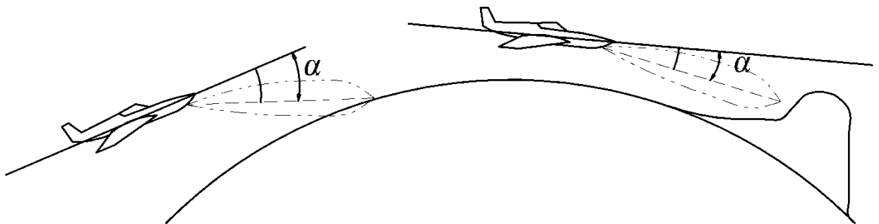
Рисунок 21 – Обнаружение препятствий радиометрическим методом.
