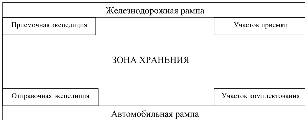
Рис. 5.1 – Принципиальная схема склада
