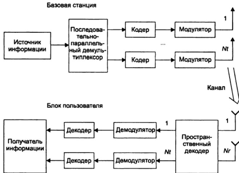
Рисунок А.1 - Блок-схема системы **MIMO**
