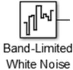
*Band-Limited White Noise* – блок генератора белого шума. Назначение: создает сигнал заданной мощности, равномерно распределенной по частоте. Параметры: *Noise Power* – мощность шума, *Sample Time* – модельное время, *Seed* – число, необходимое для инициализации генератора случайных чисел.
